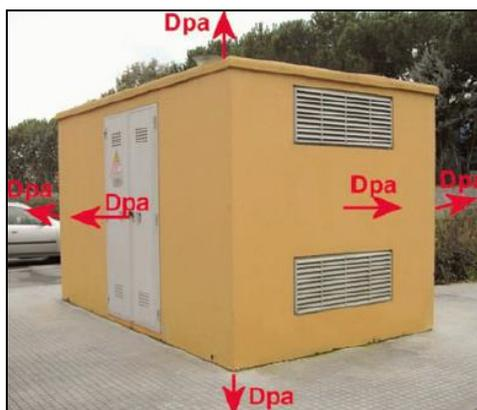
Figura 78. Esempio di distanza di prima approssimazione (dpa)
